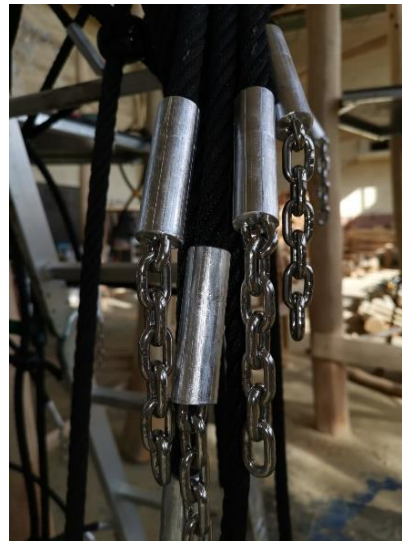
Специални алуминиеви пресовки и калибрована неръждаема верига
